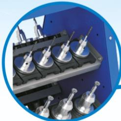
Хранение фрезерного и токарного инструмента в защитных пластиковых держателях
